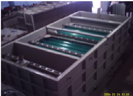
O **SÃO** Separador de Água e Óleo **CIPAM** é fabricado em polipropileno com acessórios em fibra de vidro com capacidade para atende até 30m<sup>3</sup>/hora.
